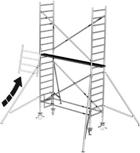
Stecken Sie die beiden 1 m Vertikalrahmen, wie im nebenstehenden Bild gezeigt, auf die Rohrverbinder der 2 m Vertikalrahmen und sichern Sie die Verbindungen mit Fallsteckern.
