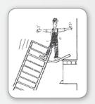
Das Überbrücken von Gerüsten zu Gebäuden durch Bohlen usw. ist nicht zulässig. Das Gerüst darf nicht als Treppenturm verwendet werden, um von dort aus auf andere Konstruktionen zu gelangen.
