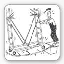
4 Die Oberfläche, auf der das Gerüst positioniert wird, muss eine genügende Belastungsfähigkeit haben. Die Struktur muss auf einem ebenen, waagerechten und unbeweglichen Untergrund stehen.
