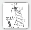
**8** Die Verwendung von seitlichen Hebevorrichtungen ist verboten.
