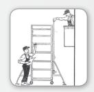
Vor der Verwendung des Gerüstes prüfen Sie, dass die Struktur korrekt und senkrecht aufgebaut ist.
