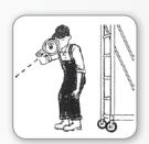
**6** Das Gerüst muss manuell versetzt werden. Passen Sie auf, dass sich auf dem Untergrund keine Gitterroste, Kabel und Betonringe befinden.
