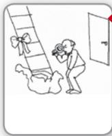
**1** Nach der Lieferung/dem Kauf sollten Sie die Leiter vor der ersten Benutzung prüfen, um den Zustand und die Funktion aller Teile sicher zu stellen. Versichern Sie sich, dass die Leiter mit dem Etikett und den Gebrauchsanweisungen nach EN 131 Norm ausgestattet ist.
