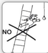
**12** Arbeiten, die eine seitliche Belastung bei Stehleitern bewirken, z.B. seitliches Bohren durch feste Werkstoffe (z.B. Mauerwerk oder Beton), vermeiden.
