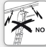
**15** Für unvermeidbare Arbeiten unter elektrischer Spannung müssen elektrisch nicht leitende Leitern benutzt werden (z.B. Glasfaserkunststoff).
