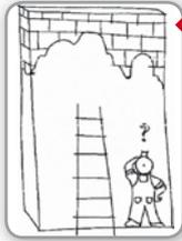
**2** Stellen Sie sicher, dass die Leiter für den jeweiligen Einsatz geeignet ist. Für die Stehleitern soll der Abstand zwischen der Standhöhe und der Arbeitshöhe 1,80 m nicht überschreiten. Die maximale Standhöhe auf einer Stehleiter ohne Sicherheitsgeländer sind auf den drei obersten Stufen andernfalls auf der Plattform mit einem 60 cm Sicherheitsgeländer.
