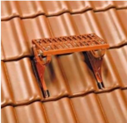
Das universal Trittflächenset entspricht der EN 516/DIN 18 160/5. Mit seinen flexiblen Laufsteghaltern kann das Trittflächenset an alle gängigen Dachgegebenheiten angepasst werden. Desweiteren sind zwei Längen (480 bzw. 800 mm) verfügbar. Passend zu Leiter und Haken ebenfalls in den Farben Stahl verzinkt/rot beschichtet/braun beschichtet sowie anthrazitgrau erhältlich.
