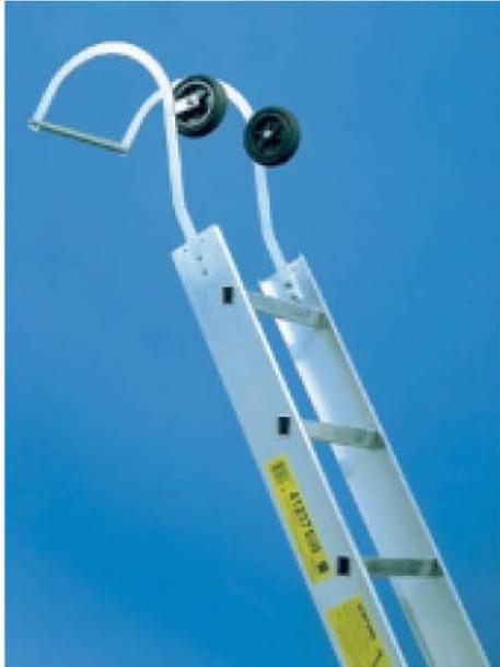
Fahrbare Firsthaken. Stahlbügel verzinkt mit 2 Laufrädern. Die Dachleiter wird mit dem montierten Firsthaken auf der Dachfläche zum First gerollt, dort umgedreht und am First eingehängt.
