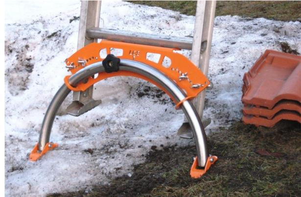
spezielle Leiterfüße mit großer Aufstandsfläche sowie mit **einem Gummi** und **einer Kralle** ausgerüstet, bieten auf unterschiedlichsten Flächen **sichern Halt**
