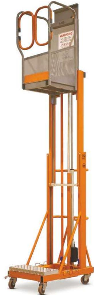
*Die besonders leichte elektrische Arbeitsbühne »UpLift5« hat ein Gesamtgewicht von 90 kg und weist eine Breite von 68 cm sowie eine Höhe von 190 cm auf. Damit soll sie auch auf engem Raum eine Person samt Werkzeug und Materialien bis auf 5 m Arbeitshöhe bringen.*
