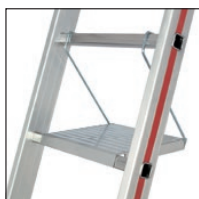
Einhängetritt für Sprossenleitern Trittbreite 300 mm, Trittiefe 255 mm. Zulässige Belastung 150 kg (1,5 kN).
