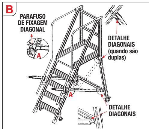
**D)** Antes de utilizar a escada bloquear o freio das rodas anteriores (detalhe A), montar os estabilizadores quando pedido para a normativa adotada, bloqueando-os firme com os grampos em dotação.
