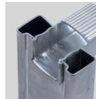
4-fach verpresste Sprossen-Holm-Verbindung für lange Lebensdauer und hohe Festigkeit. Spezialholm mit Einbuchtung außen, somit kein lästiges Anstoßen, da die Sprossenenden vertieft liegen.
