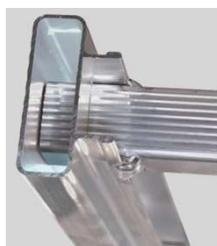
Formschlüssige, einzeln in den Holm eingelassene, beidseitig 3-fach verschweißte Sprossen-Holm-Verbindung
