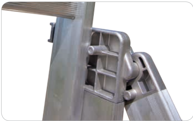
Hochwertiges Guss-Gelenk an den Holmen durch Schrauben befestigt. Extrem stabil und einfach zu verwenden sowohl als Anlegeleiter als auch als Stehleiter.
