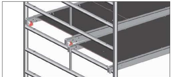
Die **roten/orangen** Schließbügel der Böden ermöglichen durch ihre speziell dafür gestaltete Geometrie den mühelosen Ein- und Ausbau durch eine Person; sie sind zuerst zu lösen und der Belag mit den geöffneten Bügeln auf die Sprosse aufzulegen, dann erst werden die gegenüberliegenden Bügel gelöst und der Belag ausgehoben.
