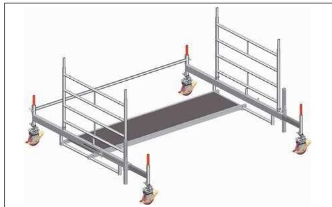
1. Die Lenkrollen 1 in die Fahrbalken 6/7 einstecken und durch Festdrehen der Flügelschrauben an den Spindelmuttern gegen Herausfallen sichern.
