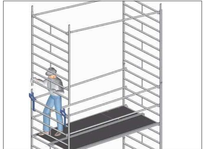
3. Diagonalen und Durchstiegsbrücke einsetzen.
