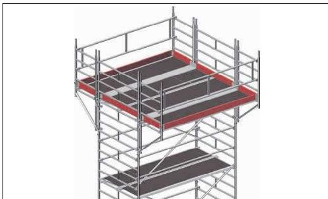
5. Auf die Konsole 0,75 m wird je eine 1,00-m-Standleiter aufgesteckt, an denen dann der zuvor demontierte Seitenschutz auf 1 m Höhe montiert wird. Anschließend kann das noch am Gerüst verbliebene Geländer auf der Höhe von 0,50 m eingebaut werden.
