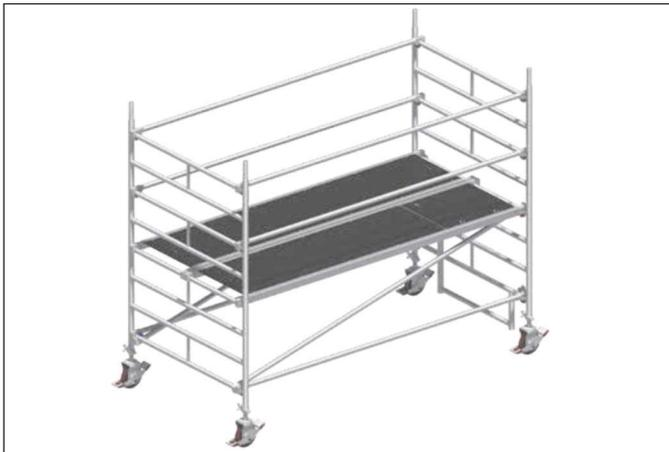
1. Die Lenkrollen **1** werden in die 2,00-m-Standleitern **17** eingesteckt und durch Festdrehen der Flügelschrauben an den Spindelmuttern gegen Herausfallen gesichert.
