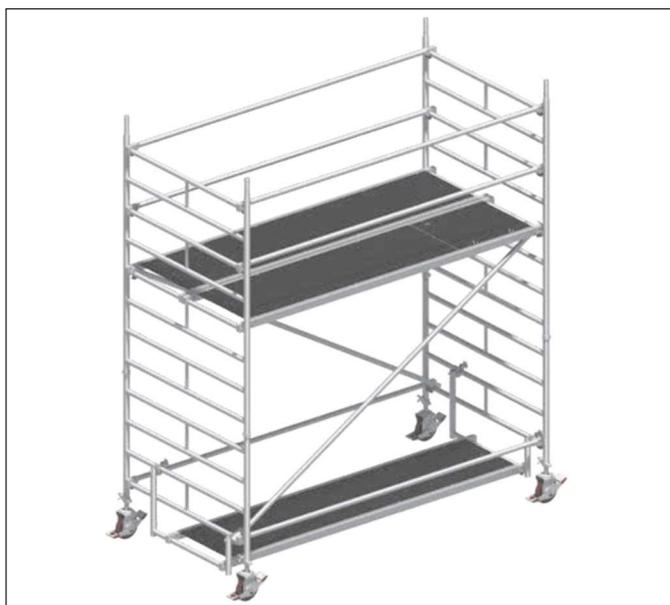
1. Die Lenkrollen 1 werden in die 1,00-m-Standleitern 18 eingesteckt und durch Festdrehen der Flügelschrauben an den Spindelmuttern gegen Herausfallen gesichert.
