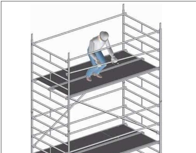
5. Auf die nächste Ebene aufsteigen und zusätzliche Geländer 14 an der zweiten Sprosse über der Standfläche montieren.
