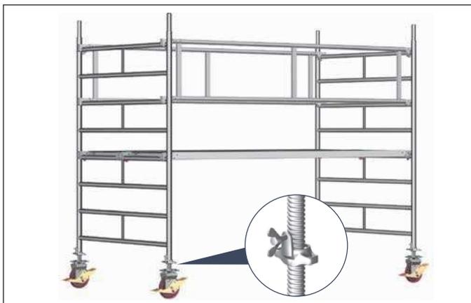
1. Die Lenkrollen 1 werden in die 2,00-m-Standleitern 17 eingesteckt und durch Festdrehen der Flügelschrauben an den Spindelmuttern gegen Herausfallen gesichert.
