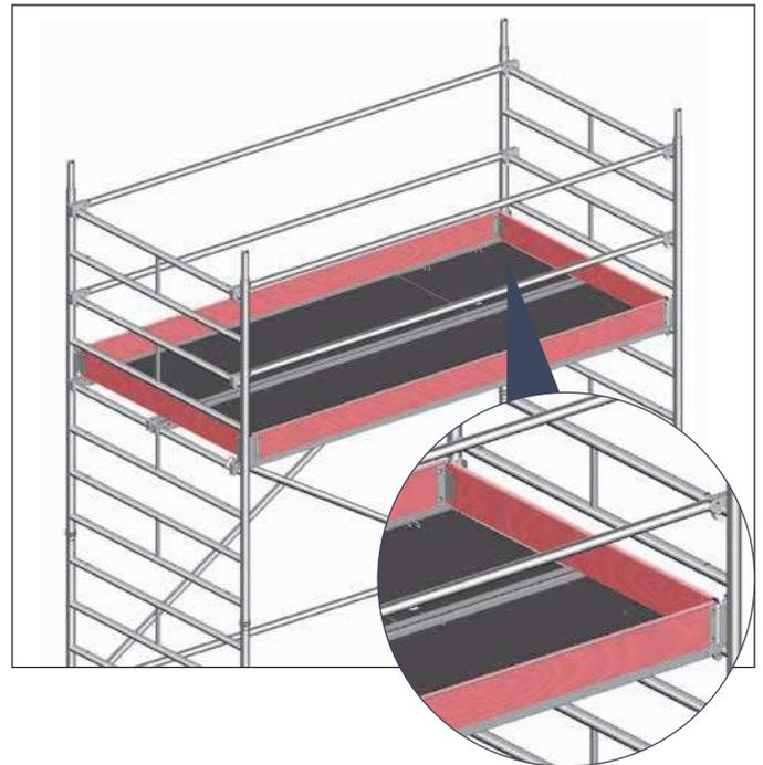
1. Zum Abschluss der Arbeitsbühne müssen Bordbretter mit Klaue 27 und Stirnbordbretter 28 angebracht werden.
