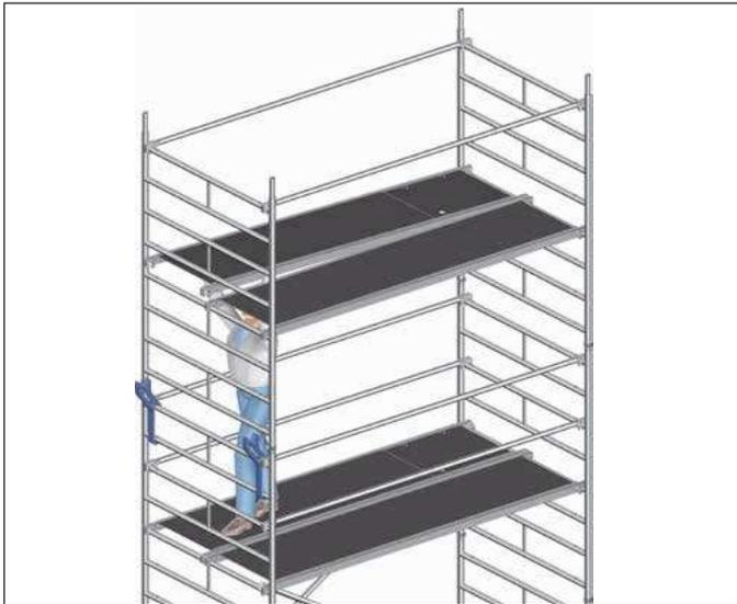
4. Diagonalen 21 und Durchstiegsbrücke 24 einsetzen. Die Diagonalen müssen auf beiden Seiten turmartig (Zick-zack-Form) eingebaut werden.
