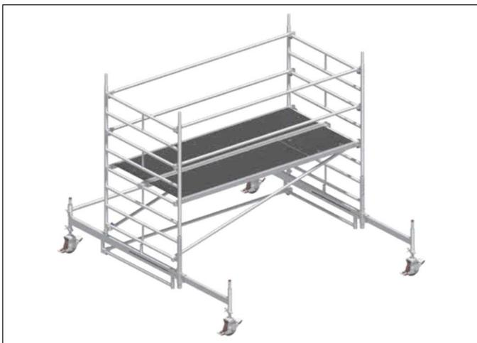
1. Die Lenkrollen 1 in die Fahrbalken 6/7 einstecken und durch Festdrehen der Flügelschrauben an den Spindelmuttern gegen Herausfallen sichern.
