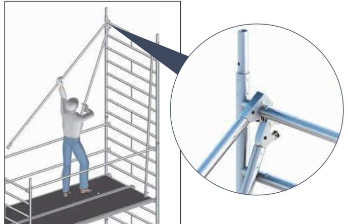
Beim Abbau einer Zwischen- oder Arbeitsbühne werden die obersten Geländer erst von der darunterliegenden Ebene aus demontiert. Dies geschieht mithilfe eines auf Kniehöhe eingebauten Geländers.
