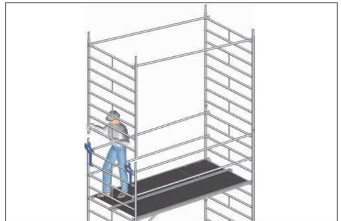
3. Standleiter mit Geländer nach oben schwenken, aufstecken und mit Federsteckern **13** sichern.
