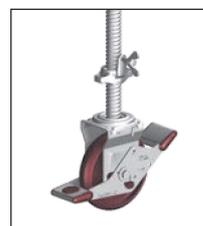
Die Lenkrollen sind im Aufbau und Arbeitszustand durch Drücken des mit Stop gekennzeichneten Bremshebels festzustellen. In gebremstem Zustand muss der mit Stop gekennzeichnete Hebel unten sein. Zum Verschieben werden die Rollen durch Drücken des gegenüberliegenden Hebels gelöst.
