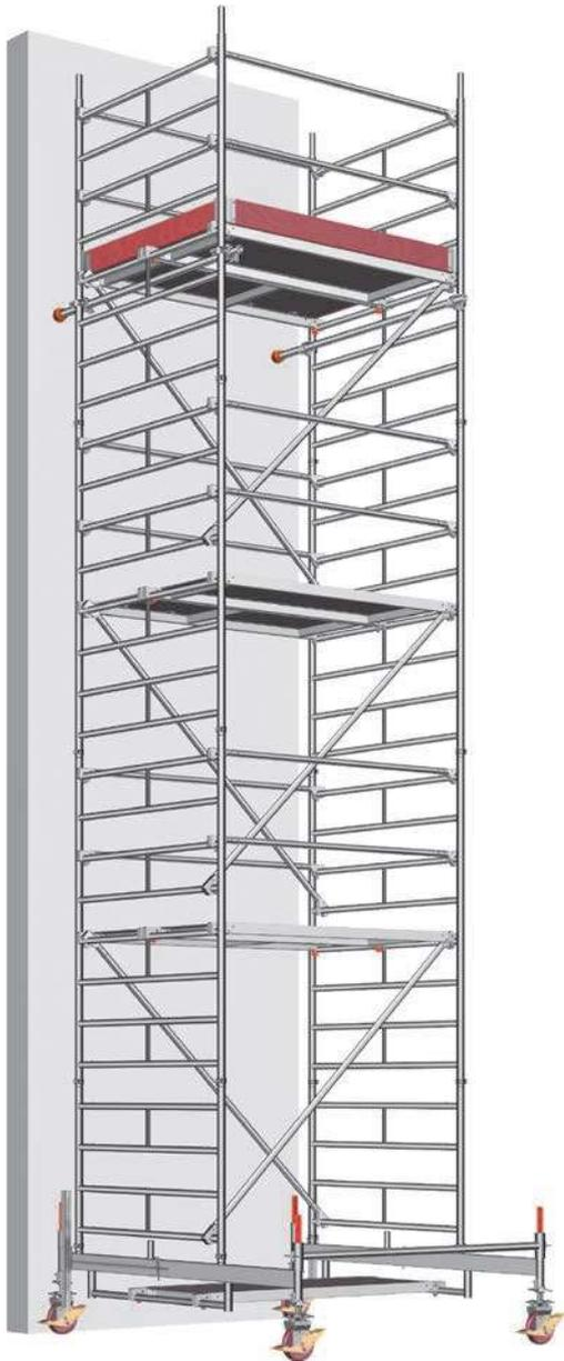
Für Arbeiten, die an einer tragfähigen Wand ausgeführt werden, kann die Ballastierung entsprechend der Tabelle **Ballastierung** (siehe Seite 8) reduziert werden. In diesem Fall sind auf beiden Seiten des Gerüsts Wandabstützungen oder Verankerungen einzubauen.
