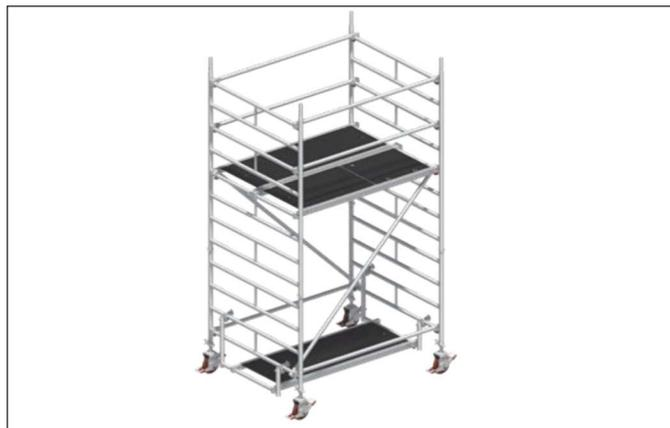
1. Die Lenkrollen 1 werden in die 1,00-m-Standleitern 26 eingesteckt und durch Festdrehen der Flügelschrauben an den Spindelmuttern gegen Herausfallen gesichert.
