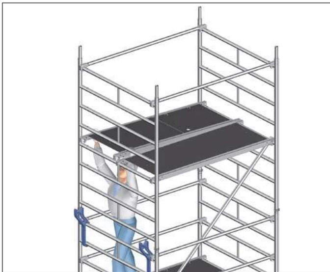
4. Diagonalen 16, Durchstiegsbrücke 23 und Belagbrücke 22 einsetzen. Die Diagonalen müssen auf beiden Seiten turmartig (Zick-zack-Form) eingebaut werden.
