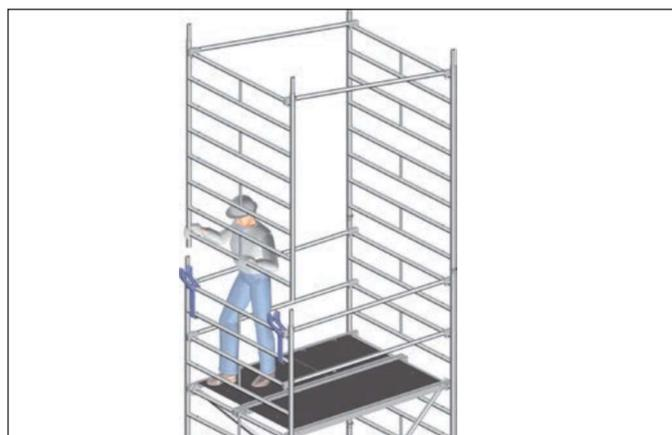
3. Standleiter mit Geländer nach oben schwenken, aufstecken und mit Federsteckern 24 sichern.
