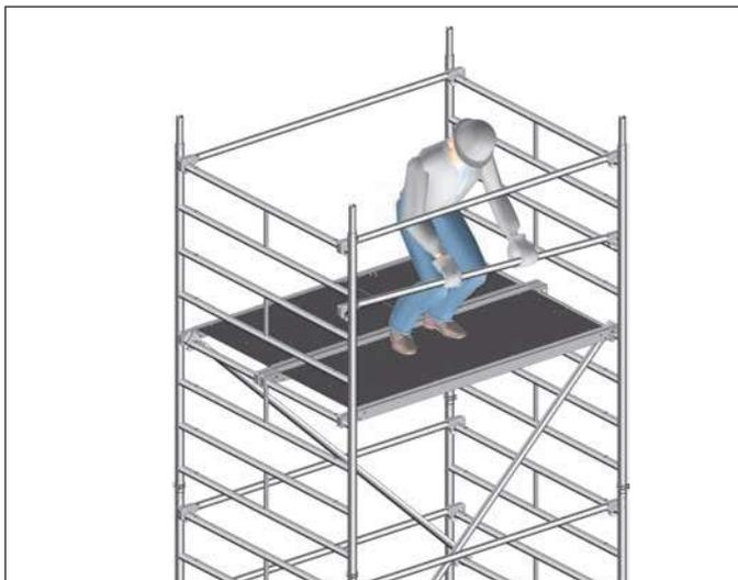
5. Auf die nächste Ebene aufsteigen und zusätzliche Geländer 12 an der zweiten Sprosse über der Standfläche montieren.
