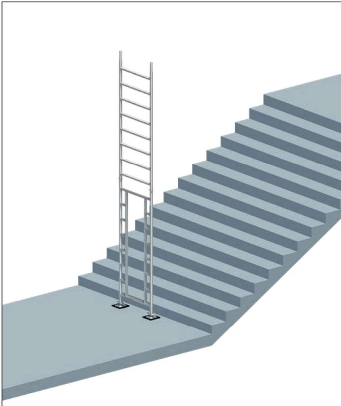
1. Als Vormontage erfolgt das Aufstecken einer Standleiter 2 m auf die Durchgangs-Standleiter **1**.
