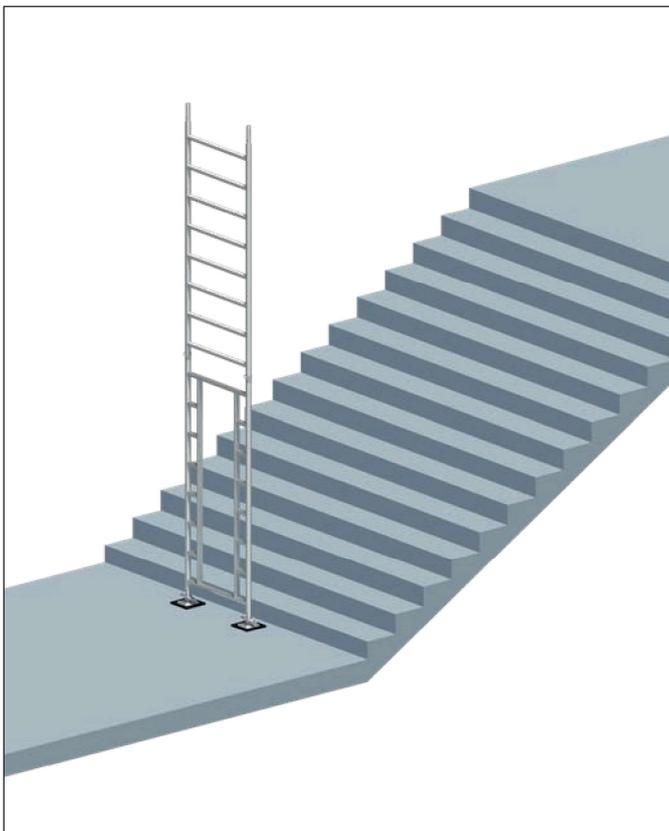
1. Als Vormontage erfolgt das Aufstecken einer Standleiter 2 m auf die Durchgangs-Standleiter **1**.
