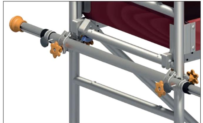
Das beidseitig teleskopierbare Abstandsrohr **5** kann nach der Befestigung mittels Gerüstkupplungen an den Holmrohren durch Lösen der Rändelschraube ausgezogen und mit dem dafür vorgesehenen Gummifuß an den entsprechenden Punkten an der Wand angelehnt werden.
