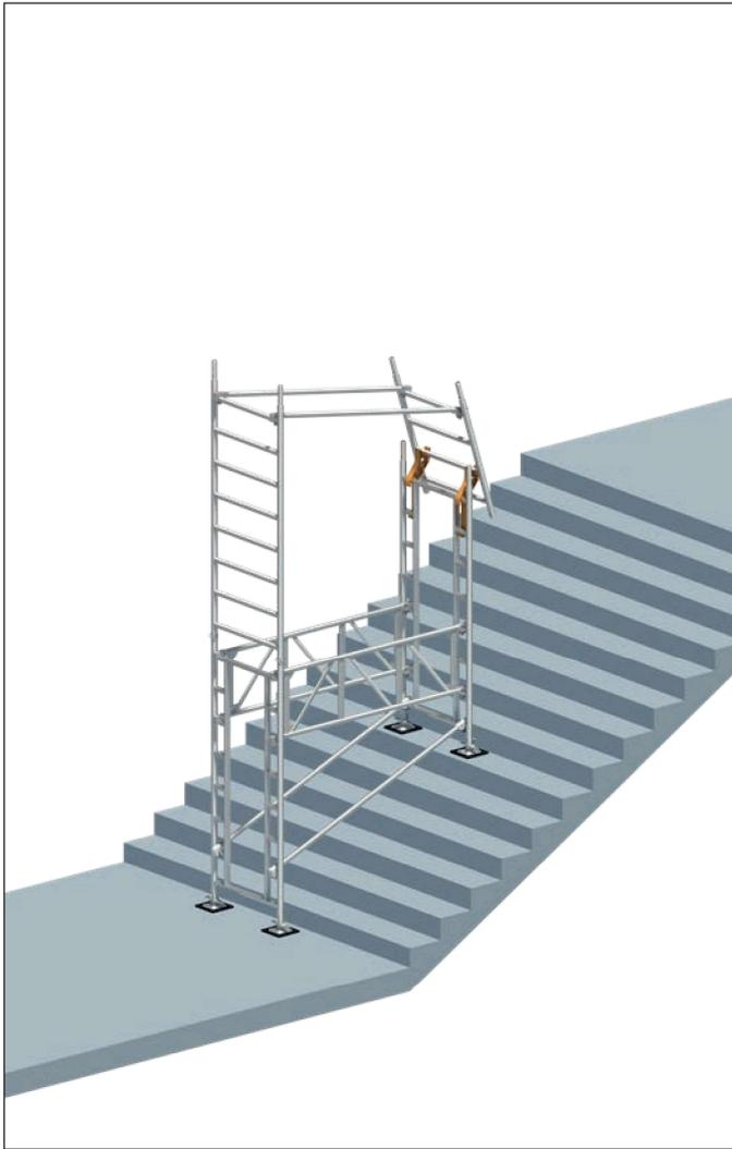
8. Montage der beiden kurzen Diagonalen **4** beginnend an der 2. Sprosse von unten.
