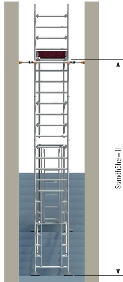
Die Konstruktion kann am Einsatzort erstellt werden, wie im Kapitel 5. Auf- und Abbau beschrieben. Die Einspannung durch das Tele-Abstandsrohr 1,25m **5** oder die Abstandsrohre 0,5m **11** (s. S. 19, Kapitel 6. Abstandsrohr-Anbau) muss stets vor dem Aufsteigen erfolgen. Ein nachträgliches Versetzen der Abstandsrohre kann erforderlich sein, da diese immer unter der obersten Plattform anzubringen sind.
