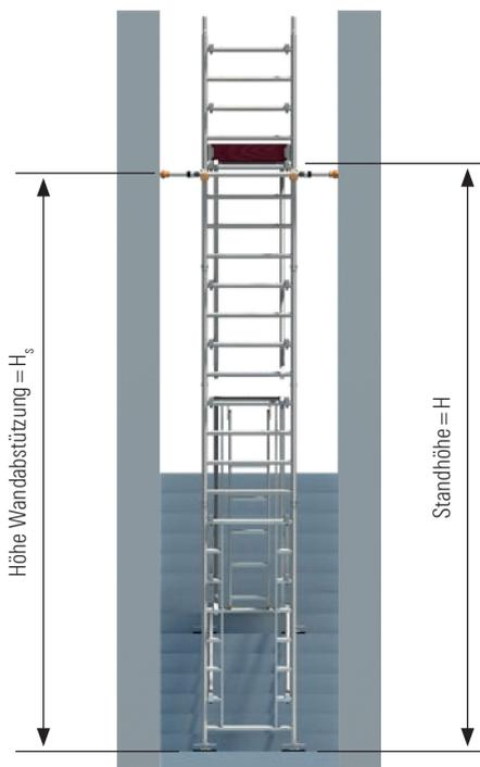
Zur Positionierung in der Höhe darf das Verhältnis zwischen der Standhöhe  $H$  und der Höhe der Wandabstützung  $H_s$  den Wert 1,5 nicht unterschreiten.
