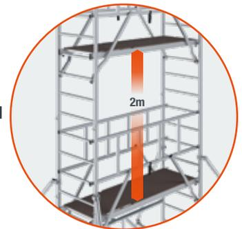
Die Anzahl der Belagbühnen wächst mit der Arbeitshöhe, so dass ein maximaler Belagbühnenabstand von 2 m sichergestellt ist.
