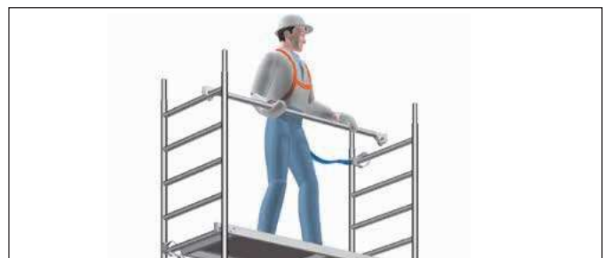
Bild 3: Sichere Montage des Geländers mit PSA
