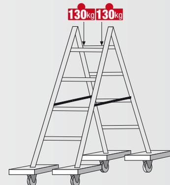
Prüfung gegen Spreizung der Gelenke (das wird auf Rollen ausgeführt)
