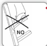
**3** Benutzen Sie niemals eine beschädigte Leiter. Die Lebensdauer einer Leiter aus Glasfaserkunststoff ist kürzer als bei einer aus Aluminium, deshalb setzen Sie sie nicht der Sonne oder der Kälte für längere Zeit aus.
