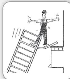
◀ **9** Das Überbrücken von Gerüsten zu Gebäuden durch Bohlen usw. ist nicht zulässig. Das Gerüst darf nicht als Treppenturm verwendet werden, um von dort aus auf andere Konstruktionen zu gelangen.
