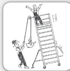
◀ **8** Die Verwendung von seitlichen Hebevorrichtungen ist verboten.
