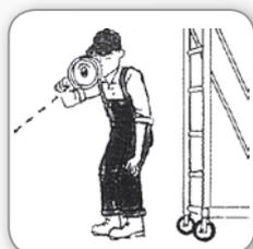
◀ **6** Das Gerüst muss manuell versetzt werden. Passen Sie auf, dass sich auf dem Untergrund keine Gitterroste, Kabel und Betonringe befinden.
