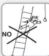
**12** Arbeiten, die eine seitliche Belastung bei Stehleitern bewirken, z.B. seitliches Bohren durch feste Werkstoffe (z.B. Mauerwerk oder Beton), vermeiden.
