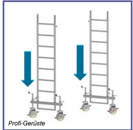
02. Durch Betätigung des Fußpedals sind alle Rollen zu arretieren.
