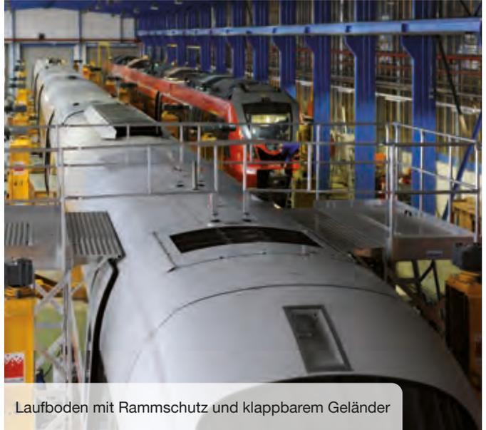
Laufboden mit Rammschutz und klappbarem Geländer
