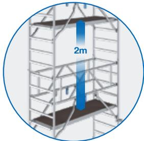
Die Anzahl der Belagbühnen wächst mit der Arbeitshöhe, so dass ein maximaler Belagbühnenabstand von 2 m sichergestellt ist.
