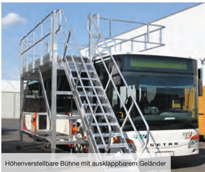
Höhenverstellbare Bühne mit ausklappbarem Geländer
