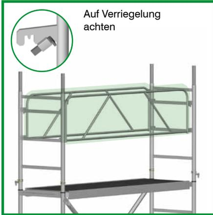
09. 2 Gerüststützen bzw. 2 Fahrausleger und Stützstangen montieren.
