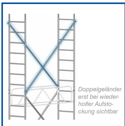
08. 2 Gerüststützen bzw. 2 Fahrausleger und Stützstangen montieren.
