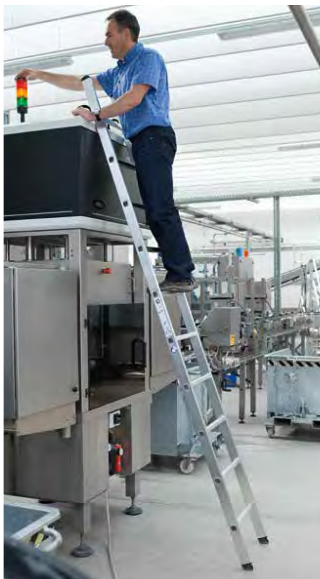
Exemplarische Darstellung, Fixierung der Leiter mit Haken
