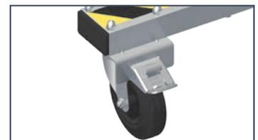
Lenkrollen mit Arretierung, die Rad und Gabelkopf blockiert, können mittels eines Richtungsfeststellers in Aufstiegsrichtung oder seitlicher Richtung fixiert werden.
