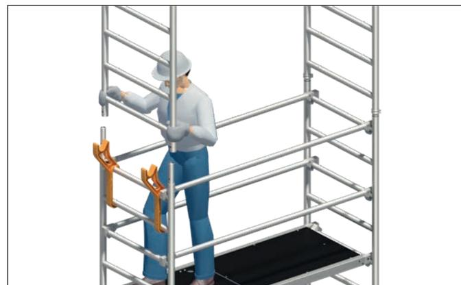
4. Durchstiegsbrücke 26 und Diagonalen 21 demontieren.
