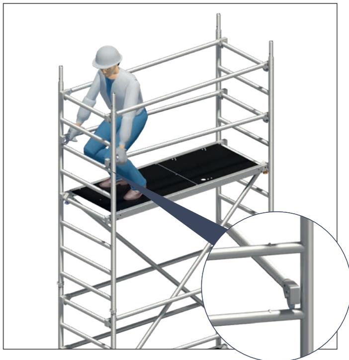
2. Einseitiges Lösen und Auflegen der Einrastklauen von beiden Zwischengeländern in 0,5m Höhe, jeweils auf der gegenüberliegenden Seite der Durchstiegsklappe.
