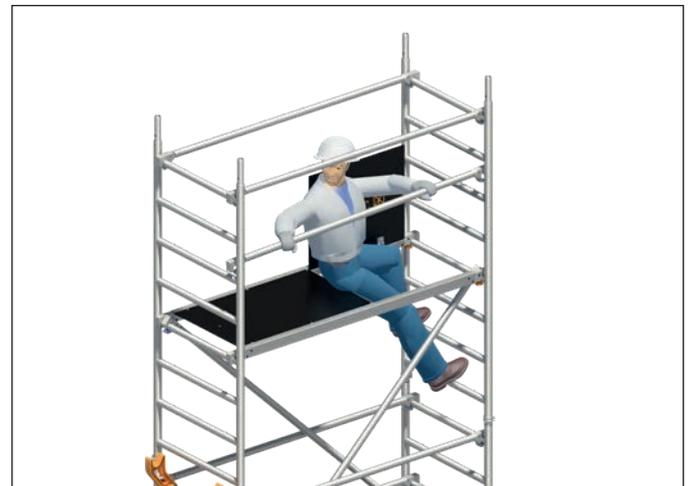
5. Innenseitiger Aufstieg über die Sprossen der Standleiter durch die dafür vorgesehene Durchstiegsklappe. In der Durchstiegsöffnung sitzend, absturzesichert durch die Holme der Durchstiegsbrücke 26, erfolgt die Montage des Zwischengeländers der nächsten Lage, hierzu werden die Geländer 18 an den zweiten Sprossen über der Standfläche montiert.
