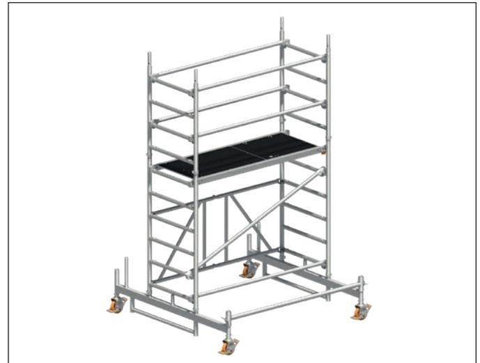
1. Die Lenkrollen 2 in den Fahrbalken 9 einstecken und mit Schrauben und Muttern gegen Herausfallen sichern.
