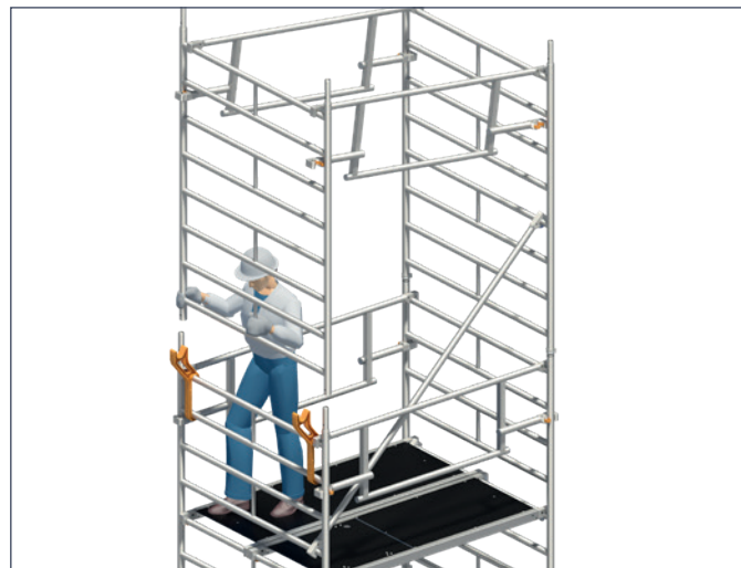
2. Standleiter mit Doppelgeländern nach oben schwenken und auf unterer Standleiter aufstecken.
