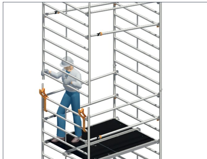
2. Standleiter mit den Geländern und Uni Telegeländern nach oben schwenken und auf unterer Standleiter aufstecken.
